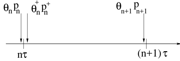
Figura 7.4: Definição das variáveis a tempo discreto para o rotor.
