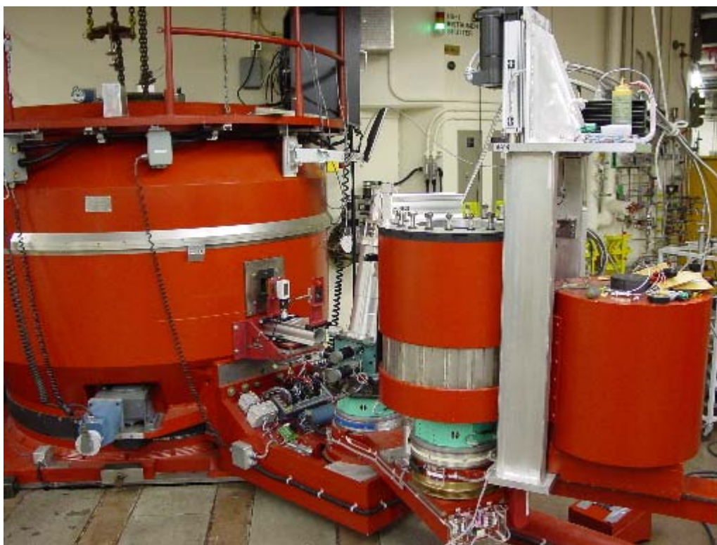
Figure 5: Espectrômetro de três eixos HB1 Polarized TAS , do SNS-ORNL.
