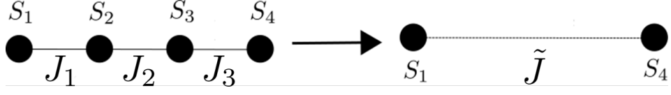
Figura 2.1: Representação esquemática do processo de dizimação. Os sítios 2 e 3 são congelados num estado de singlete e, através de teoria de perturbação, calculamos os efeitos deste procedimento no restante da cadeia.
