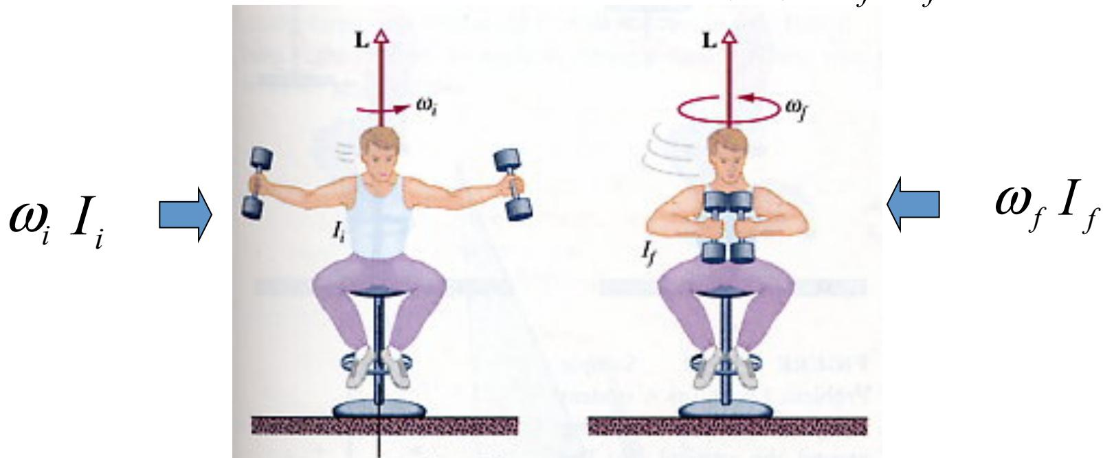
Com a aproximação dos halteres ( $I_f < I_i$ ) a velocidade angular do sistema aumenta.
