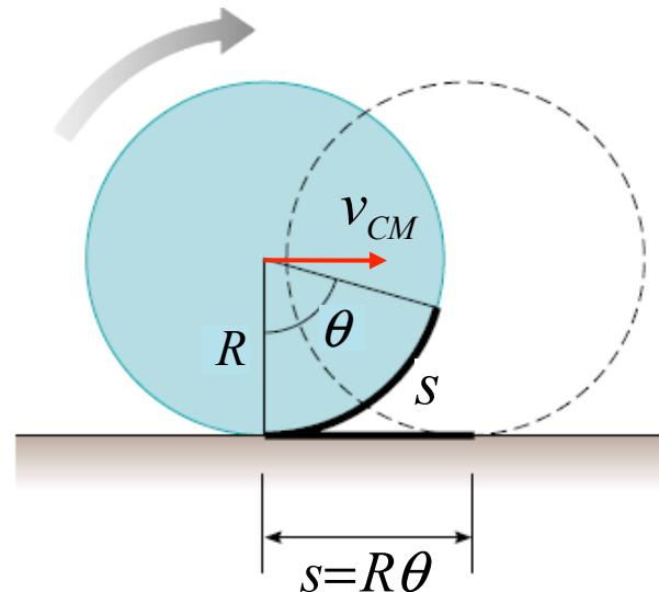
A velocidade do CM é dada por:  $v_{CM} = \frac{ds}{dt} = R \frac{d\theta}{dt} = R\omega$
