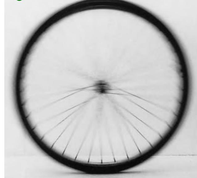
Figura da esquerda: o rolamento sem deslizamento pode ser descrito como uma rotação pura com a mesma velocidade angular  $\omega$  em torno de um eixo que sempre passa pelo ponto P de contacto (eixo instantâneo de rotação).
