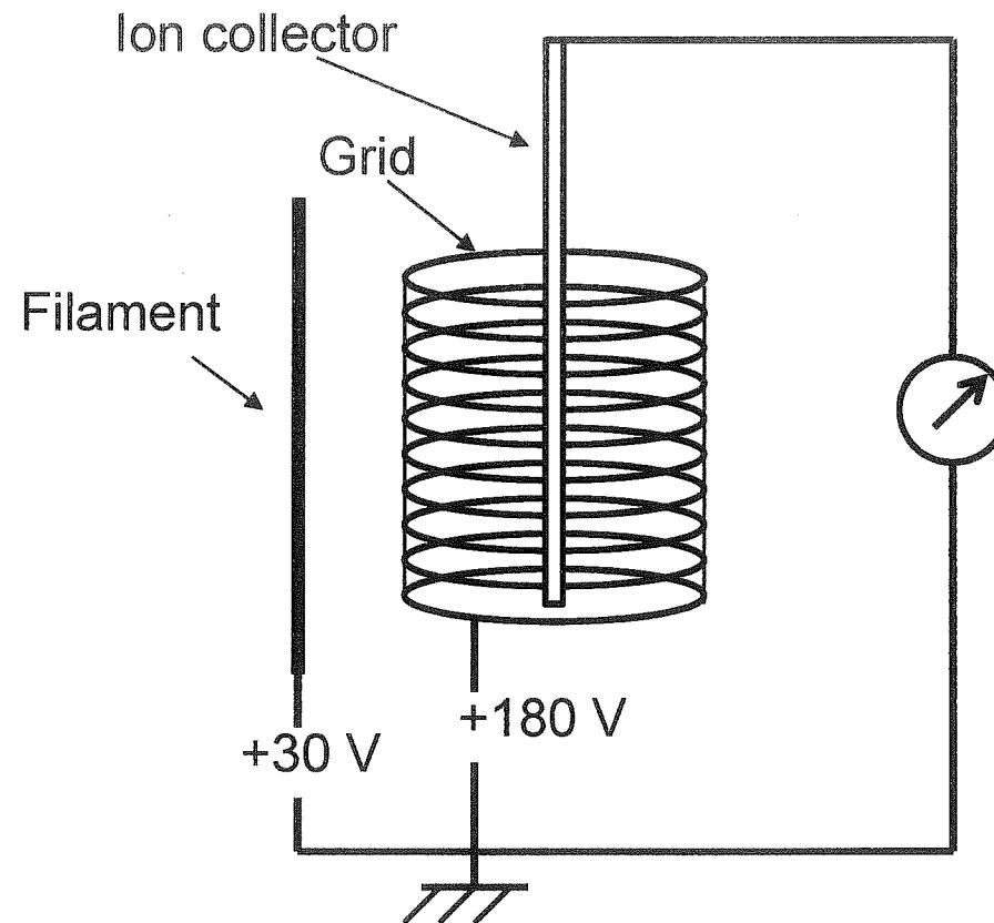
Figura 12. Conexões elétricas num sensor de Bayard-Alpert
