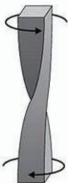
Figura 3.23 Corpo submetido a um esforço de torção.
