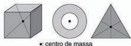
Figura 3.37 Centros de massa de três corpos de forma regular.
