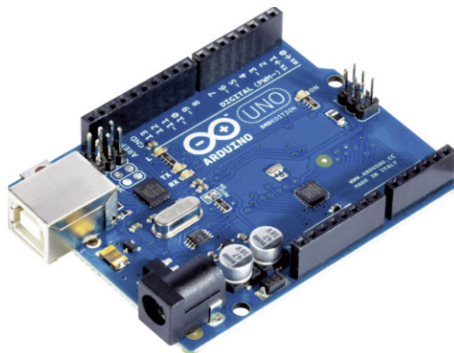
Figura 8 – Placa de Arduino Uno
