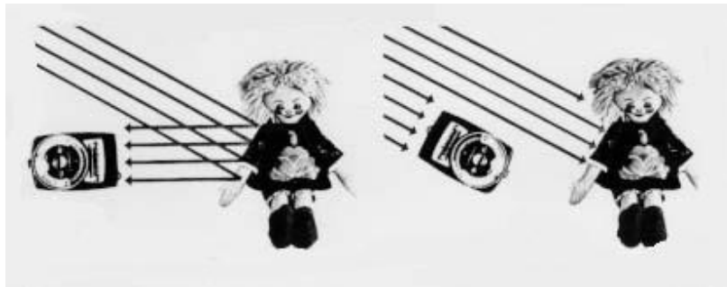
Fig.9.12 - Sistemas de leitura com fotômetro manual
