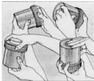
Fig.9.15 - Agitação do tanque de revelação
