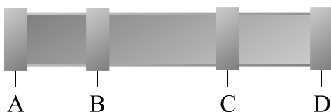
Figura 2 – Indicação dos contatos na amostra supercondutora relacionada com os contatos na saída do criostato.
