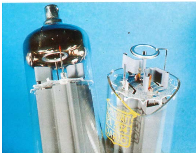
Fig. 6.49: Válvula eletrônica com anel contendo bário como aprisionador (Fig. 1 Tech. Paper 202)
