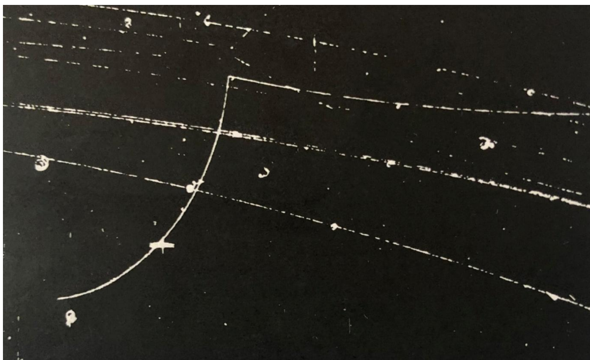
Figura 4.4. Traços numa câmara de bolhas de hidrogênio de 72 polegadas do Lawrence Radiation Laboratory. O evento de interesse é a colisão de um pion incidente com um próton do hidrogênio para formar a partícula K^0 que não tem carga e não deixa traço mas decai em dois pions de cargas opostas (reação K^0 \rightarrow \pi^- + \pi^+ ) identificados pelos seus traços com curvaturas opostas.
