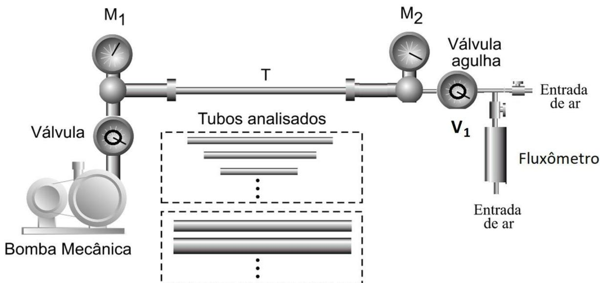
onde  $M_1$  e  $M_2$  são medidores tipo capacitivo,  $T$  = tubo cuja condutância deve ser medida. Se  $V_1$  estiver aberta e a bomba estiver funcionando, temos uma corrente molecular  $Q$  passando pelo tubo, e podemos medir uma diferença de pressão entre suas extremidades através dos medidores  $M_1$  e  $M_2$ . Se medirmos a quantidade de gás que passa por unidade de tempo pelo tubo, podemos determinar a condutância de um tubo experimentalmente utilizando a expressão:
