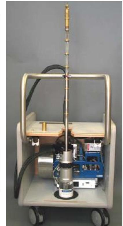
Este processo de refrigeração se utiliza de uma mistura de dois isótopos de hélio: hélio-3 e hélio-4. Quando resfriada abaixo de aproximadamente 900 mK a mistura passa por uma separação de fases espontânea para formar uma fase rica em  $^3\text{He}$  (a fase concentrada) e uma fase pobre em  $^3\text{He}$  (a fase diluída). Concentração finita da  $^3\text{He}$  na Fase Líquida Diluída.
