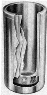
Figura 6. Dewar de metal mostrando o anteparo de radiação de cobre no espaço em vácuo e o reservatório de carvão ativado (em baixo).
