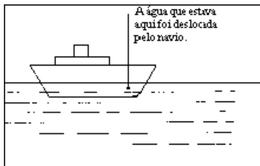
Figura 7. O peso referente ao volume de água deslocado pelo navio (empuxo), equilibra o peso total do navio fazendo com que o mesmo flutue.
