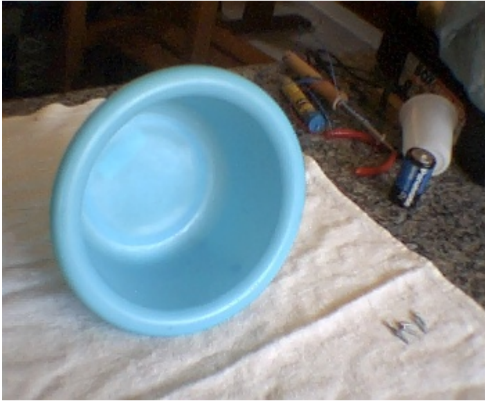
Fig.05: Foto da bacia utilizada para servir de caixa resonante, o diâmetro da bacia é de 20 cm e a profundidade 10 cm.
