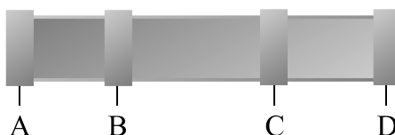
Figura 2 – Indicação dos contatos na amostra supercondutora relacionada com os contatos na saída do criostato.
