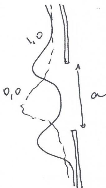
Colocando uma abertura de diâmetro "a" na cintura, podemos dar a preferência p/ amplificar o modo  $\text{TEM}_{0,0}$
