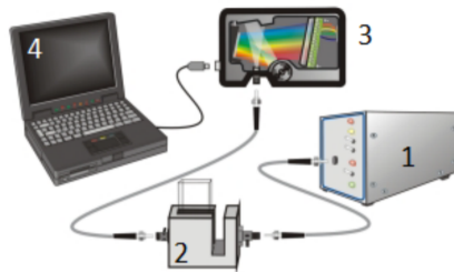
Figura 1: Esquema da aparelhagem utilizada, sendo (1) a fonte de luz, (2) a amostra analisada, (3) o aparelho que separa o espectro luminoso e (4) o computador com o software para análise. [4]
